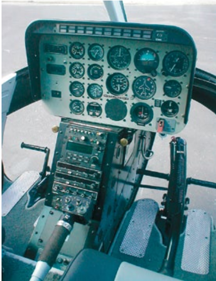
Органы управления вертолетом: ручка управления циклическим шагом (справа); ручка «Шаг-Газ» (в центре), педали – впереди перед креслами пилотов
