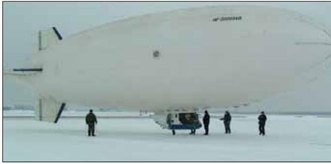
дирижабле AV-1 подкласса ВХ-4 (объем оболочки 1600–3000 м<sup>3</sup>), именно на том, на котором 7 февраля 2005 г. двумя россиянками был установлен женский мировой рекорд скорости на тепловом дирижабле. Экипаж 2-местного теплового дирижабля, состоящий из командира воздушного судна
